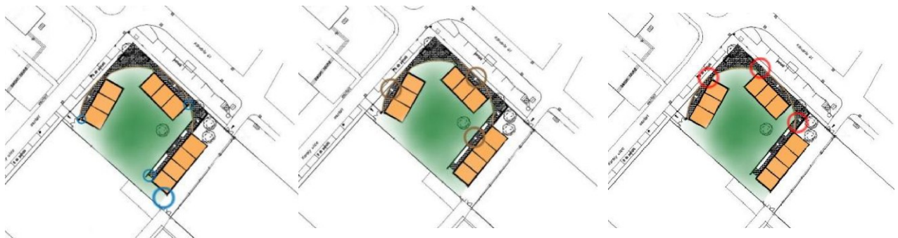
KÉP21,22,23: piros: Kapu, bejárat és kék: udvari kijárat, barna: belső közlekedő mag kijelölése a helyszínrajzon (saját ábra)
