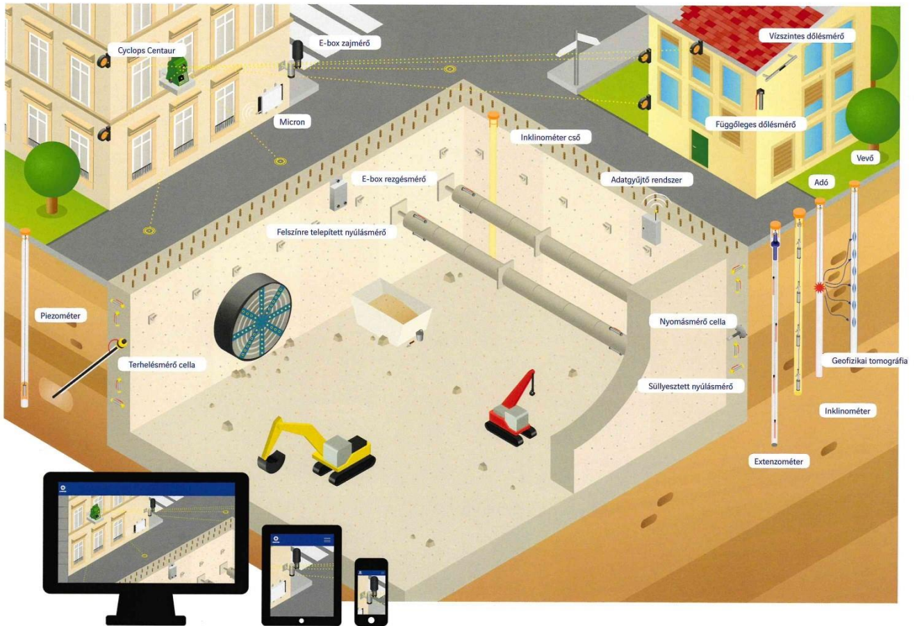
28. ábra: Városi munkagödör építési folyamatait is lehet elemezni. [Sixense]
