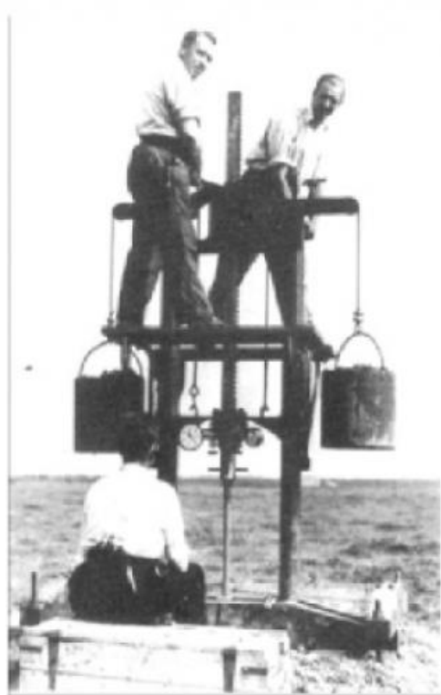
7.ábra : Holland statikus szondázás az 1940-es években. [Lunne, T., Robertson, P.K., Powell, J.J.M. (1997)]
